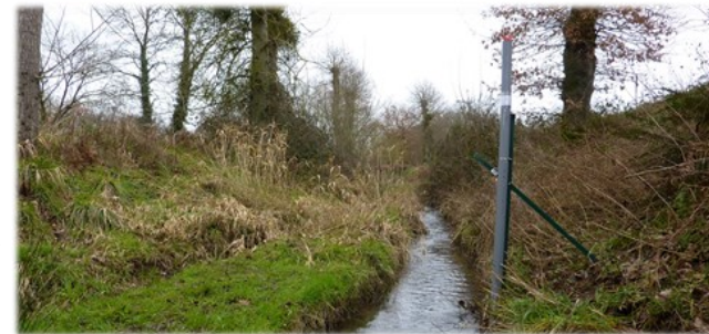
Dispositif de suivi du niveau d'eau sur un affluent du Néal (Forum des marais atlantiques)
