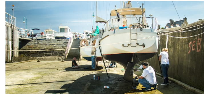
Carénage en cours (Ville de Saint-Malo)
