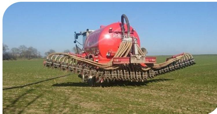
Epandeur de lisier équipé d'une rampe
